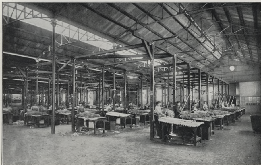
Abb. 99. Gewinnung der Wolle von den Schaffellen in einem frigorifico.
