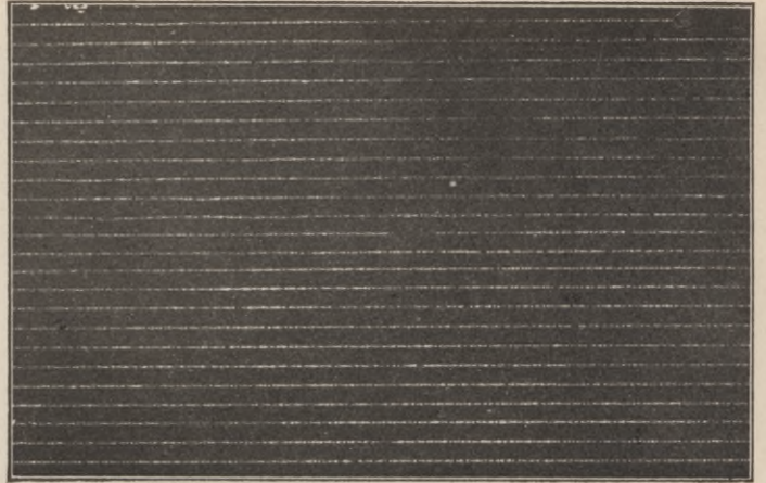
Fig. 5. Pendeldiagramm bei nahezu völliger Ruhe der Mauer. 13. 12. 1916. Maßstab 1 : 1,5.
