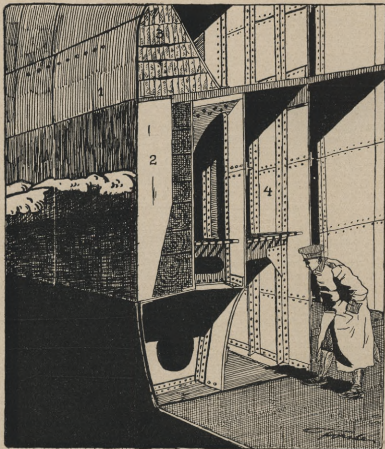
Abb. 3. Querschnitt der Panzerung des Eisenschiffs „Dürth“ (1893 in Dienst gestellt), als Beispiel für die Panzerung der älteren Eisenschiffe. 1 Außenhaut; 2 Gürtelpanzer; 3 Kordamm; hinter dem Gürtelpanzer die Panzerhinterlage, dahinter der äußere Wallgang, dahinter (4) der innere Wallgang; 5 Panzerdeck, in Wirklichkeit aus einer doppelten Plattenlage zusammengesetzt, hier einfach gezeichnet.
