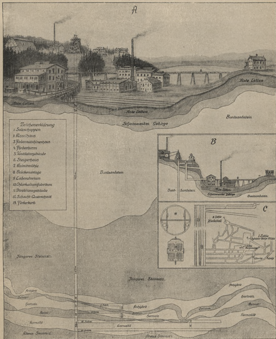
Abb. 1. Schematische Darstellung der Anlagen eines Kalibergwerkes.
