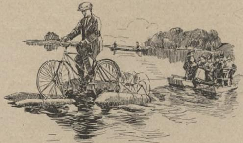
Abb. 6. Wasserfahrrad mit Schaufelrad-Antrieb beim Schleppen eines Floßes.
