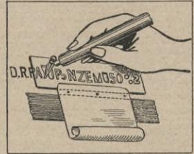
Abb. 12. Wahres Normograph ermöglicht es, Druckschriften mit der Feder herzustellen.
