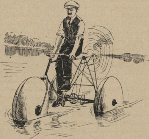
Abb. 1. Schweizers Wasserfahrrad mit Luftschraubenantrieb.
