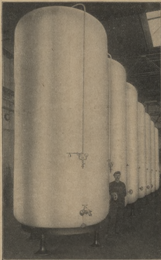
Abb. 4. Stehende Aluminium-LagergeßäÙer von je 150 Hektoliter Inhalt. (Konstruktion: W. C. Heraeus, Hanau.)
