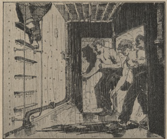
Abb. 3. Der dritte Vorschlag: Beim Öffnen der Heizraumtür tritt eine Veriefelungsanlage in Tätigkeit, die Gase und Dämpfe niederschlägt und so ihr Nachdringen verhindert.
