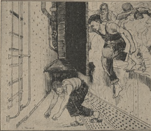
Abb. 2. Der zweite Vorschlag: Unter dem durchbrochenen Schott ist eine Druckluftleitung angeordnet, die bei Dampfgefahr geöffnet wird. Der dann durch die Bodenöffnungen aufsteigende Luftstrom bildet für den Dampf eine unüberschreitbare Barriere und erleichtert so das Entkommen der Heizer.
