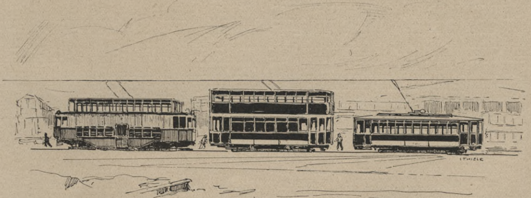
Abb. 5. Vergleich eines gewöhnlichen Straßenbahnwagens mit dem ersten und dem neuesten (3.) Zweistöck-Wagen der Wiener Straßenbahnen.
