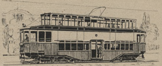
Abb. 4. Schaubild des dritten Zweistöck-Wagens der Wiener Straßenbahnen.
