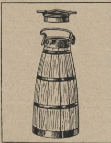
Abb. 3. Milchtransportkanne aus Holz mit Aluminiumeinsatz, System Basse und Fischer.
