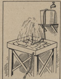
Abb. 8. Vorrichtung zum Wässern von photographischen Abzügen oder Platten, als Ersatz der Wasserleitung.
