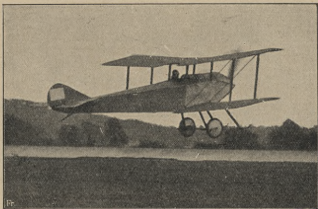
Abb. 4. Englischer 80 PS-Shopwith-Doppeldecker, entwickelt 160 km Stundengeschwindigkeit.
