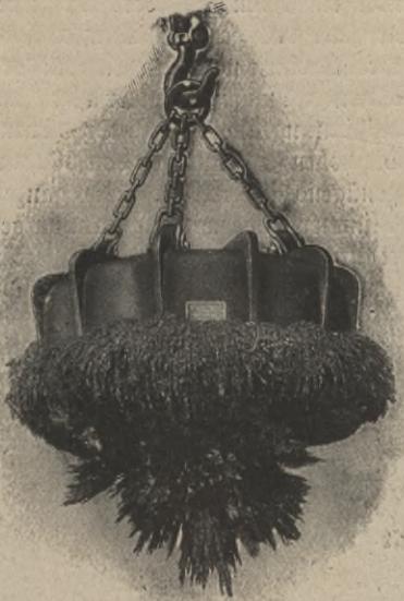
Abb. 1. Lastmagnet mit Feilspänen.
