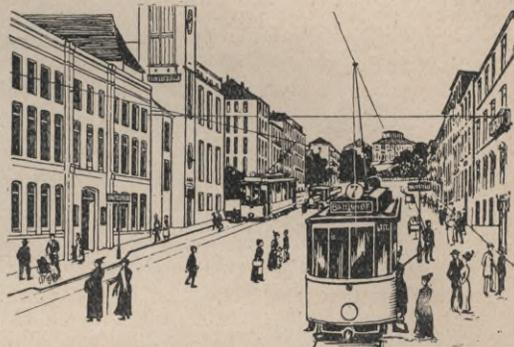
Abb. 4. In durch starken Fahrverkehr belebten Straßen könnte man die Bürgersteige durch Ausbuchtungen so nahe an die Gleise der Straßenbahn heranbringen, daß den Fahrgästen das Warten auf dem Fahrdamm oder dessen Überkreuzen beim Ein- und Aussteigen erspart bliebe.
