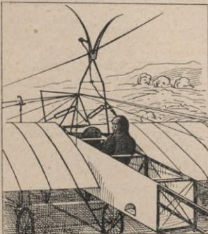
Abb. 2. Befestigung der Fanggabel am Flugzeug.
