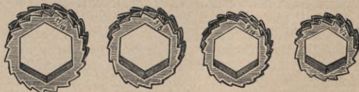
Abb. 6. Nüsse verschiedener Größe zum „Rapid“-Schraubenschlüssel.
