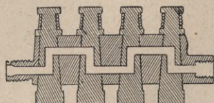
Abb. 2. Die Hähne im Schnitt, Leitung geöffnet.
