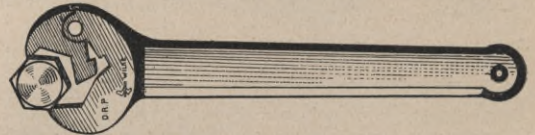
Abb. 9. Der Sicherheits-Schlüssel (System Wülke) beim Erfassen der Mutter.
