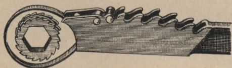
Abb. 4. Das Einsetzen einer Nut in den Schraubenschlüssel „Rapid“.
