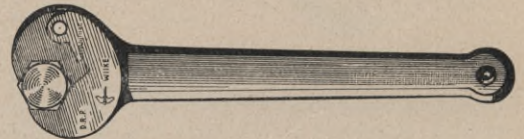
Abb. 10. Der Sicherheits-Schlüssel (System Wülke) hält die Mutter von 5 Seiten umfaßt.
