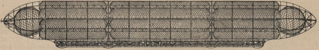
Abb. 1. Ansicht des Unger'schen Luftschiffs mit einseitig entfernter Außenhaut. Ideeller Längenschnitt.
