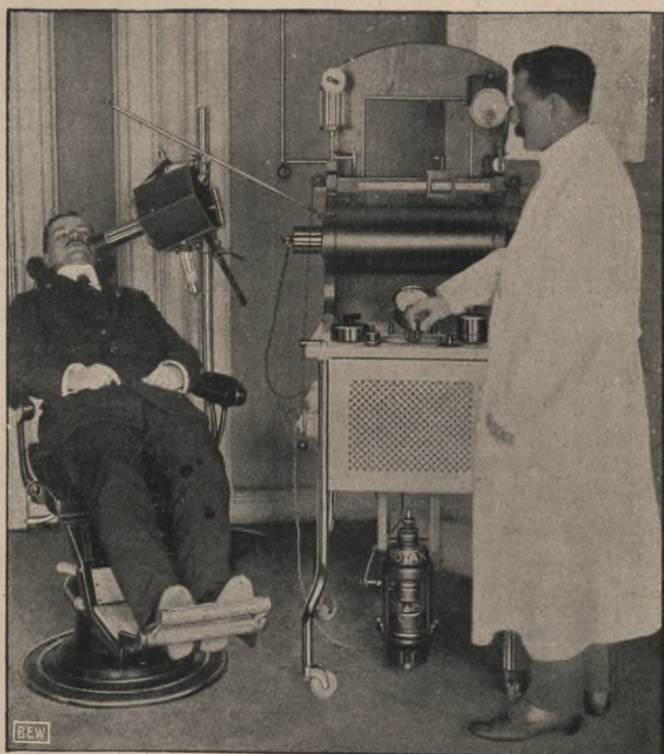
Abb. 4. Zahnaufnahme mit Hilfe des Röntgen-Apparats. (Spezialkonstruktion „Rotax“ der „Sanitas“-Elektrizitäts-Gesellschaft.)
