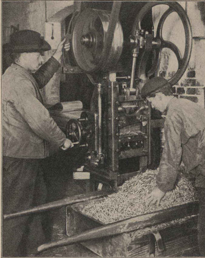
Abb. 3. Die Holzbänder werden durch die Abschlagmaschine in dünne Stäbchen geschnitten.
