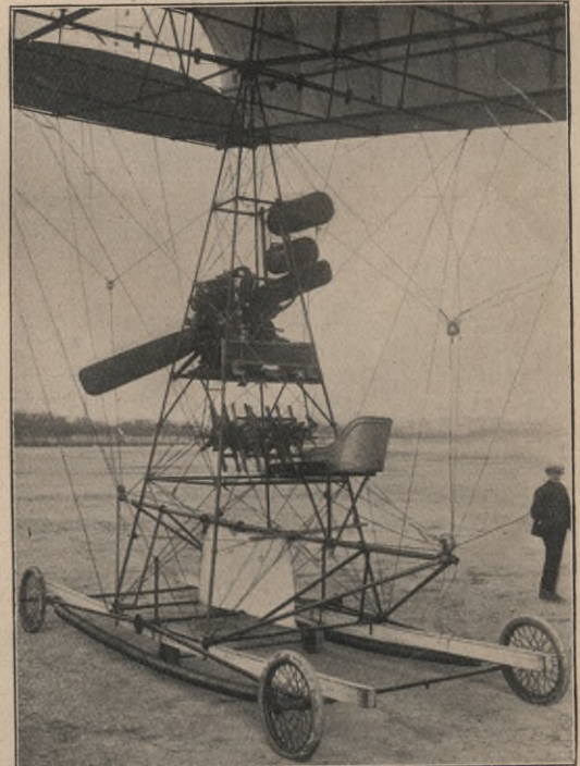
Abb. 2. Landungsgestell, Maschinenanlage und Sitz der Aéraptère „Domingo“. Vor den Sitzen die Winden für die Steuer. Die langen Spiralfedern zwischen den Rädern dienen zum Abfedern des Gestells.
