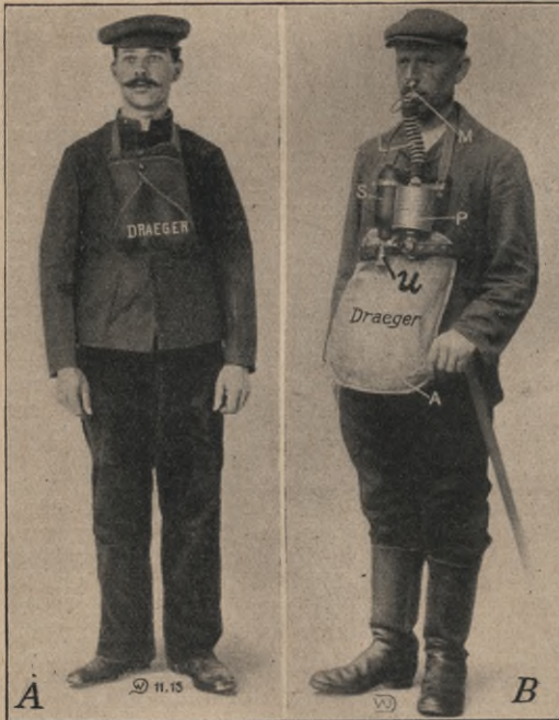
Abb. 1. Bergmann mit Draeger-Selbstretter. A Apparat geschlossen, wie er gewöhnlich getragen wird; B Apparat im Betrieb.
