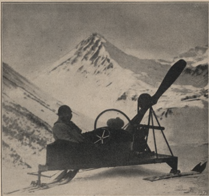
Legrain's Motorschlitten mit Propellerantrieb.
