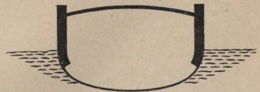
Abb. 4. Wie sich die Dicke des Deckpanzers bei einem modernen Kriegsschiff zur Dicke des Seitenpanzers verhält.
