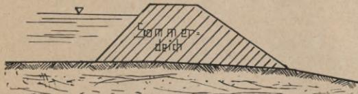
Abb. 2. Querschnitt eines Sommerdeichs; Innenböschung flach, Außenböschung steil.
