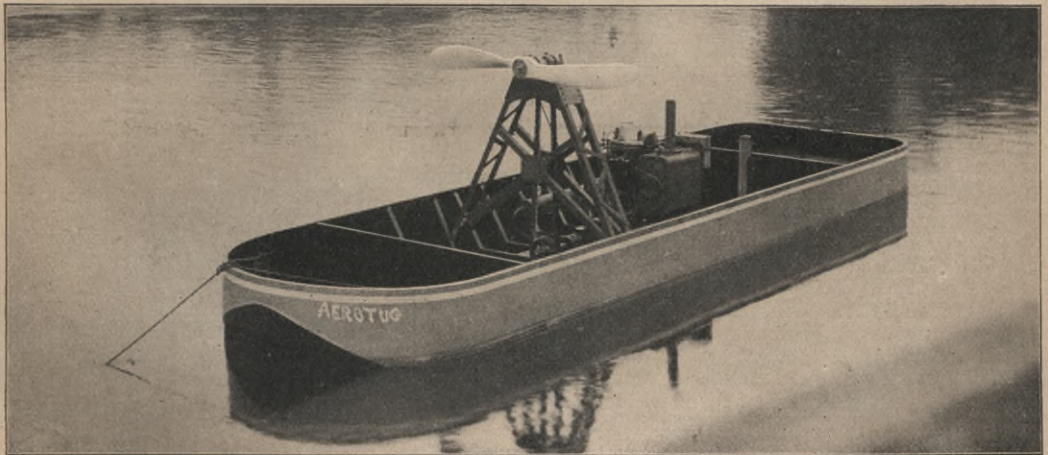
Schleppschiff mit Luftschraubenantrieb, das selbst die flachsten Wasserläufe befahren kann.
