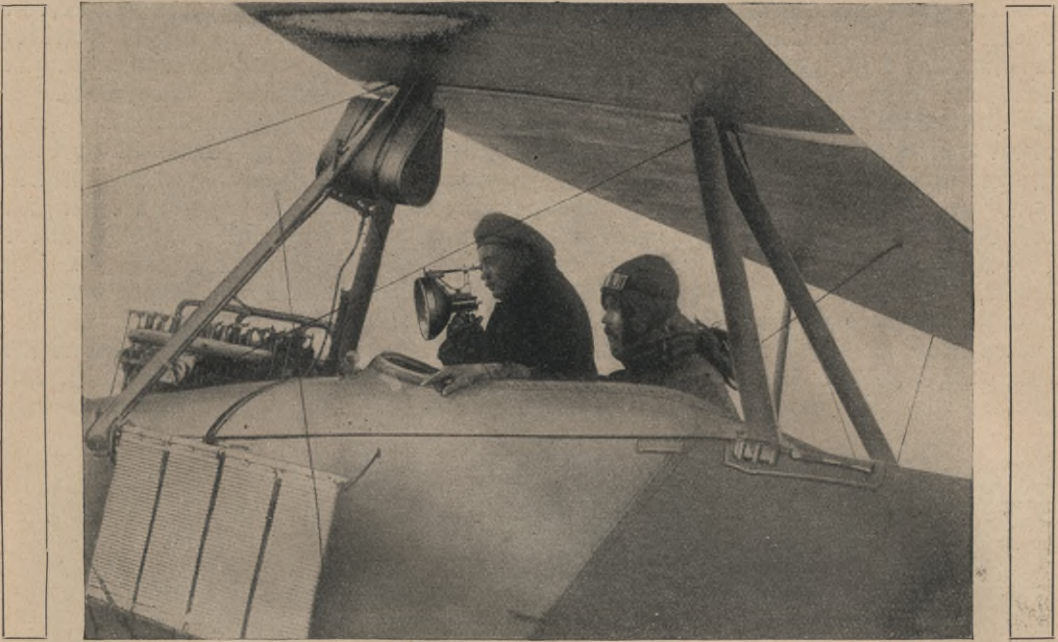
Abb. 5. Der Flieger teilt seine Beobachtungen mit Hilfe des Donath'schen Signalspiegels einer Erdstation mit.
