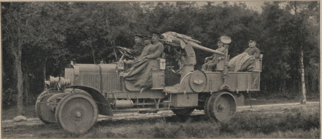
Abb. 2. 6,5 cm-Ballonabwehrkanone System Ehrhardt in Fahrstellung.
