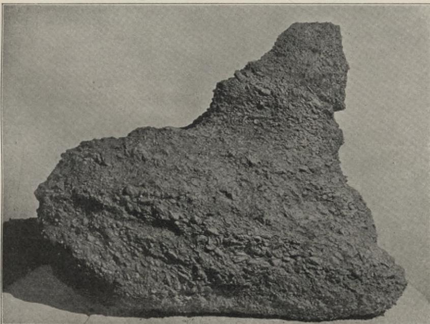
Fig. 29. Zementierter Fluß-Schotter an der Waalbrücke. — Maßstab 1 : 8.
