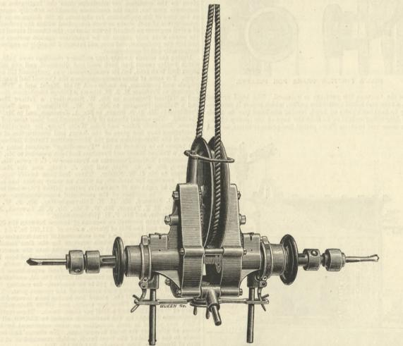
Fig. 6-SHARP, STEWART, AND CO.'S PORTABLE BOILER DRILLING MACHINE.
