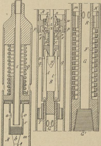
Auslösung wird durch den Konus *b* der Kolbenstange *t* bewirkt, der die Daumen beim Niedergang des Kolbens *k* auseinander drückt.
