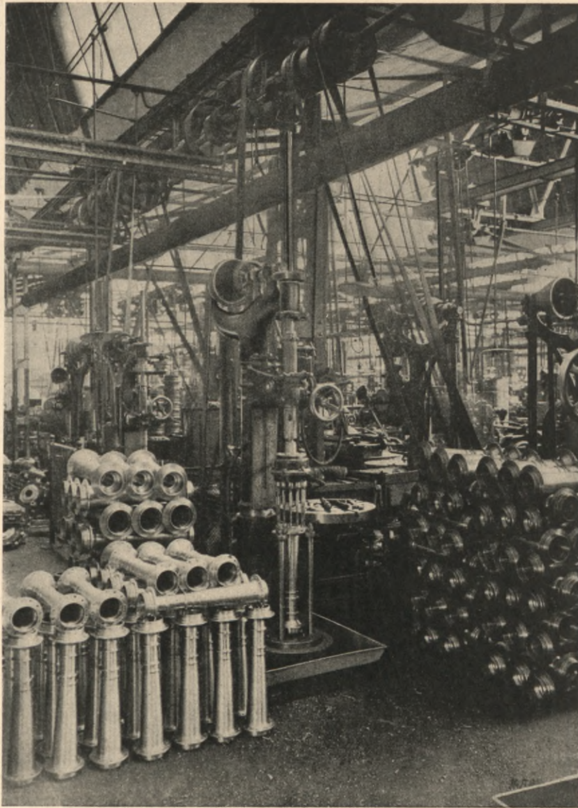
Vielfachbohrmaschine, Herstellung von Cardan-Traghülsen.
