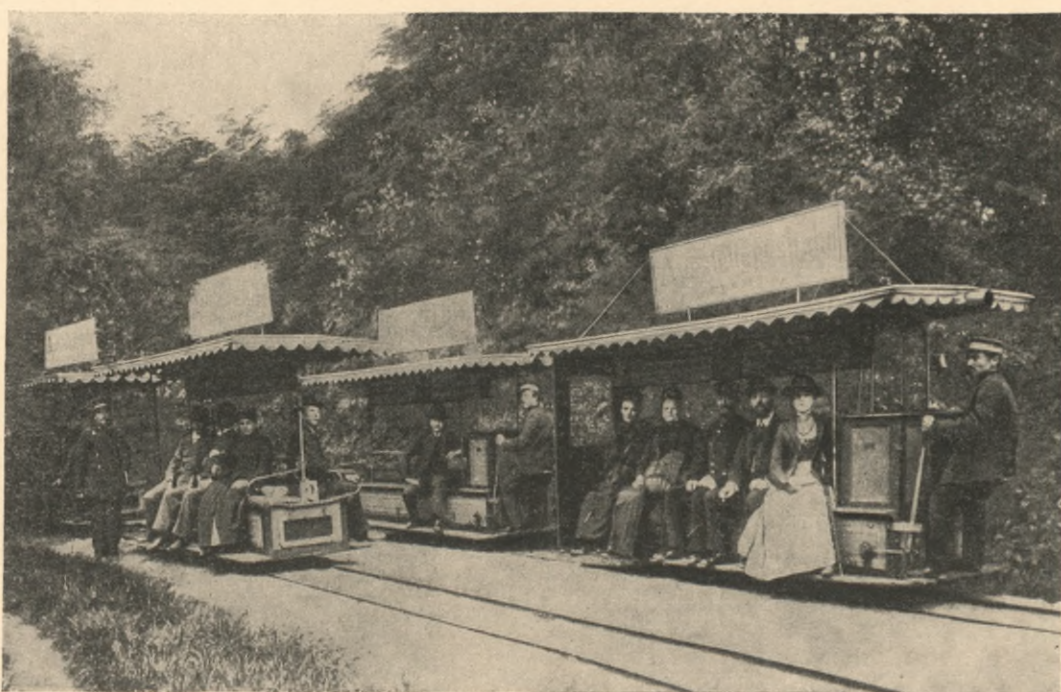
Ausstellungsbahn mit Antrieb durch Daimler-Motoren (1897).
