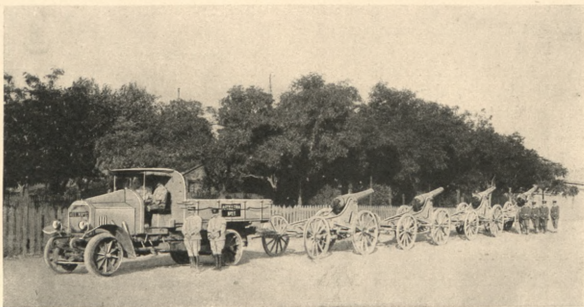
Mercedes-Zugwagen mit Vierräderantrieb und eingebauter Kabelwinde, geliefert für die spanische Heeresverwaltung.
