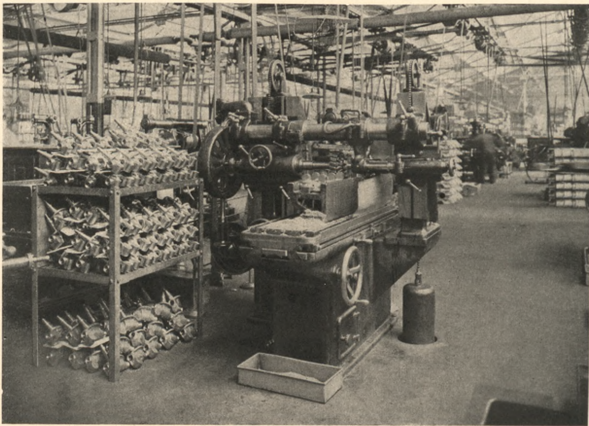
Teilansicht der Fräserei (Achsschenkel-Fräsbank).
