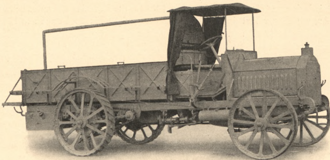
23pferdiger Armeelastwagen aus dem Jahre 1905/06 für Deutsch-Südwestafrika mit Kettenantrieb, Tragkraft 2 1/2 Tonnen und 1 Anhängewagen von 2 Tonnen.
