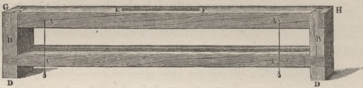
GH, règle de 20 pieds. BD, BD, bouts de règles joints à l'équerre. AC, AC, lignes perpendiculaires et fils à plomb. EF, petit canal de cinq pieds de longueur.
