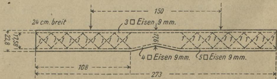
die untere Einlage wegen des Momentes unter den Schienen in den Schwellenteilen mit Kreuzfeldern auf 5 Quadrateisen von 9 mm Seite gebracht werden. Die obere Einlage genügt durchweg mit 3 solchen Eisen, da sie als Druckeinlage sehr wenig Wirkung hat und als Zugeinlage des Mittelquerschnittes nur dreier Eisen bedarf.
