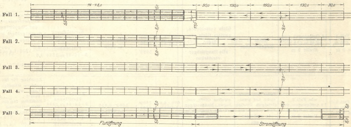
Abb. 57 bis 61. Grundrißanordnung der eisernen Ueberbauten.
