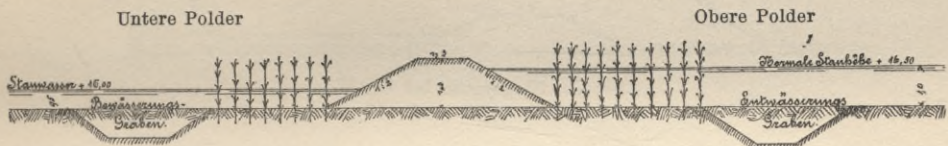
Abb. 6. Querschnitt durch die Polderdämme 1) .
