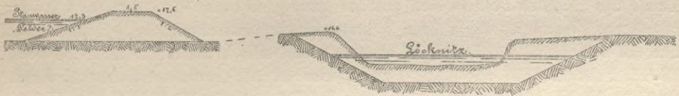
Abb. 8. Querschnitt des Sommerdeiches längs der Lößnitz.
