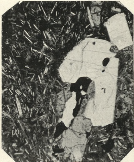
Fig. 4. Hypokristallin-porphyrische Struktur. Melaphyr.
