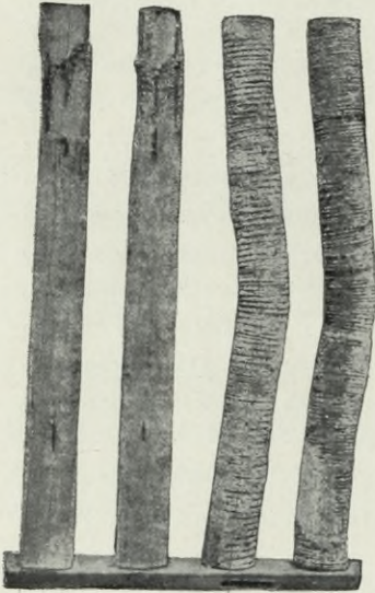
Fig. 6. Plastische Deformation durch zentrischen Druck überanstrengter spiralumschnürter Prismen.
