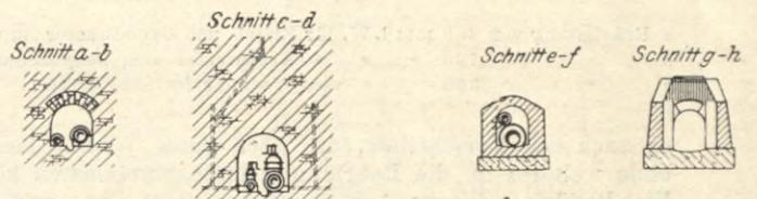
Horizontalschnitt durch den Schieberschacht.
