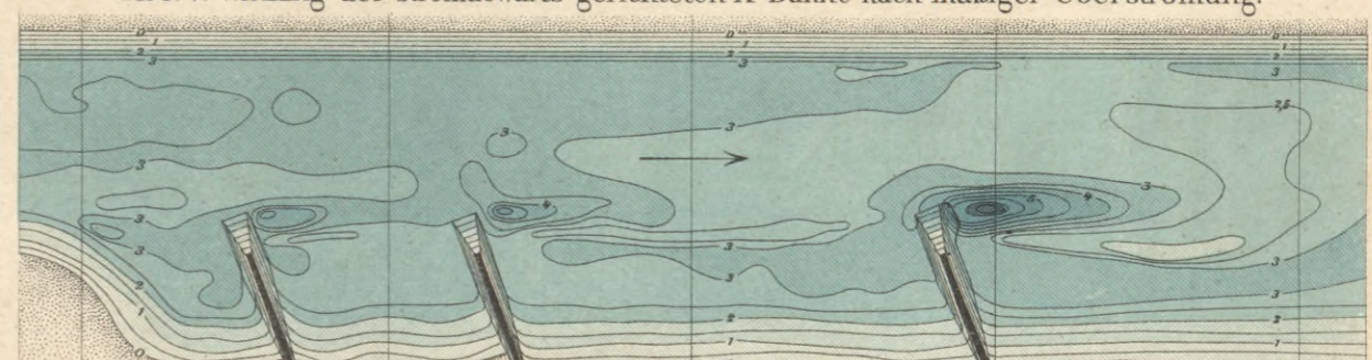
Abb. 8. Wirkung der stromaufwärts gerichteten A-Buhne ohne Überströmung.
