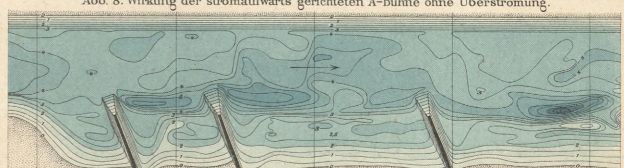
Abb. 9. Wirkung der stromaufwärts gerichteten A-Buhne nach mäßiger Überströmung.
