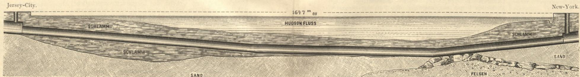
Fig. 1. Der Tunnel unter dem Hudsonflusse zwischen New-York und Jersey-City.
