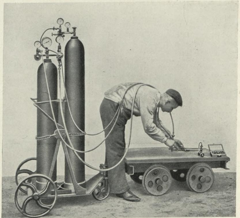
Abb. 16. Transportable Wasserstoff-Sauerstoffanlage nebst Schneidbrenner in Betrieb
