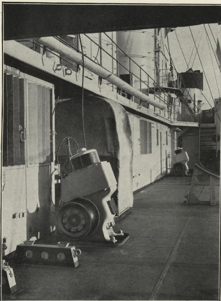
Abb. 14. Aufstellung der Kohlenwinde mit schräger Welle an Bord S. M. S. „Braunschweig“
