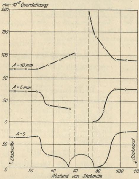
Fig. 20. Querdehnungen  $\epsilon_2$  der Längeneinheit an verschiedenen Stellen des Stabes, gegeben durch den Abstand von Stabmitte und den Abstand  $A$  vom Lochquerschnitt.
