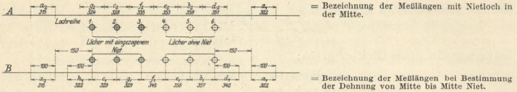
Fig. 3. Anordnung der Meßlängen zur Ermittlung der Dehnungen.
