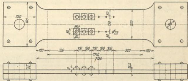
Fig. 2. Abmessungen des Probestabes.
