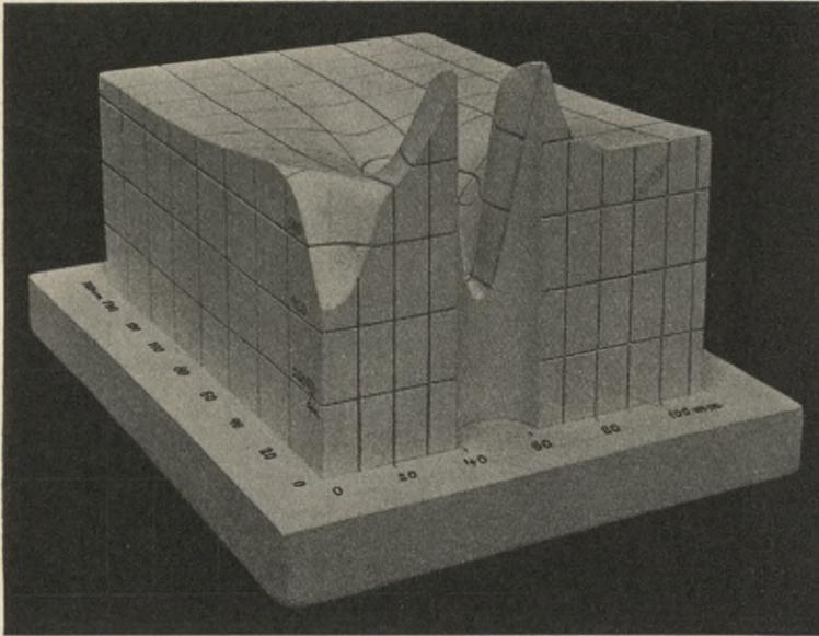
Fig. 28. Körperliche Darstellung für die Verteilung der Zugspannungen.
