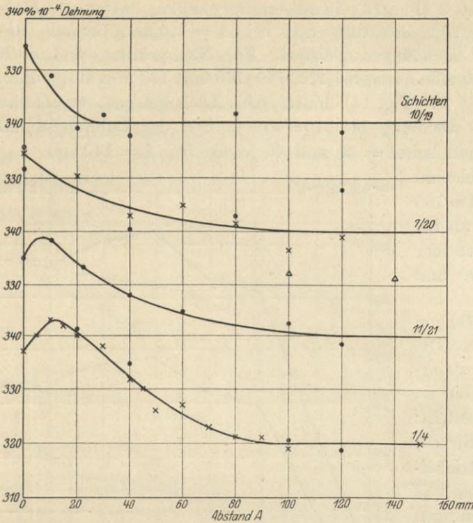
Fig. 15. Dehnung der einzelnen Breitenschichten bei 20t Belastung mit zunehmendem Abstände A vom Querschnitt  $a \propto a$  (Fig. 7).
