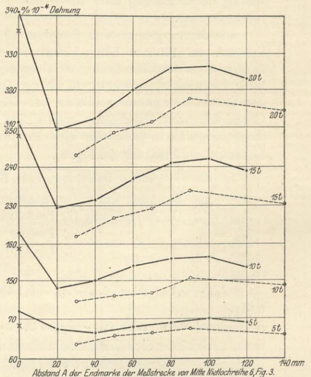
Fig. 11. Mittlere Dehnungen in der Breitenschicht 18 (Fig. 7) bei wachsendem Abstände  $A$  von Mitte Nietlochreihe 6 (Fig. 3).
