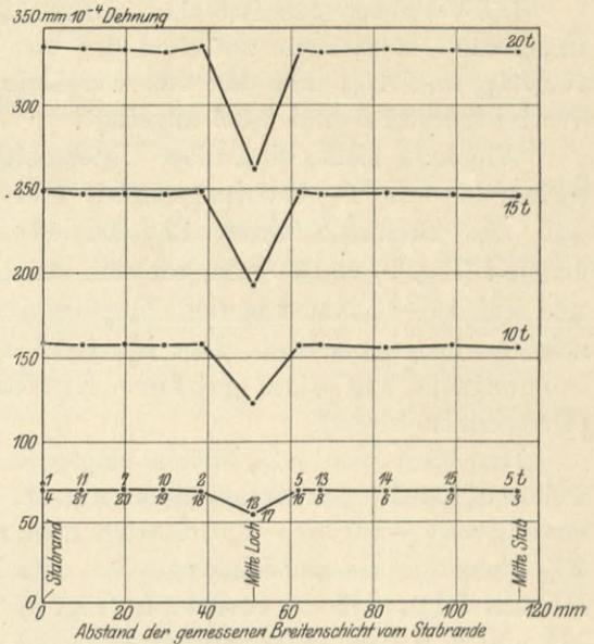
Fig. 8. Mittlere Dehnung in Proz.  $10^{-4}$  in verschiedenen Breitenschichten bei den gleichen Belastungen.
