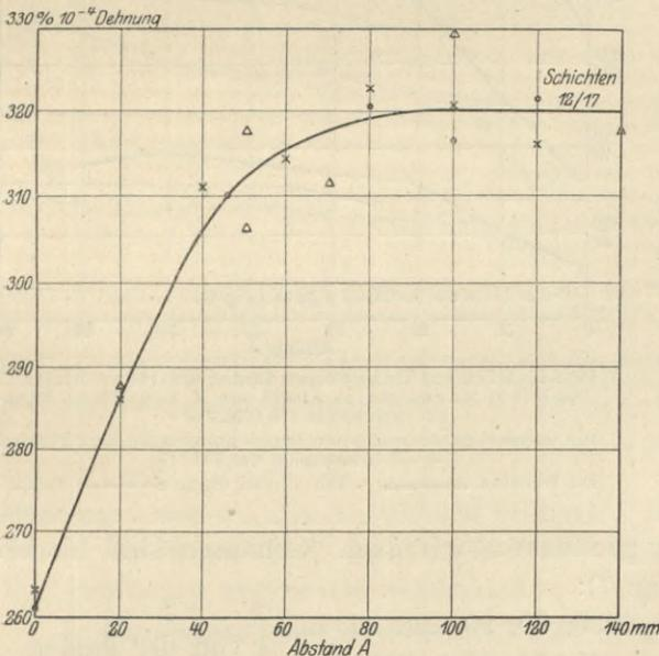
Fig. 16. Dehnung der Breitenschichten 12 und 17 bei 12t Belastung mit zunehmendem Abstände A vom Querschnitt  $a \propto a$  (Fig. 7).
