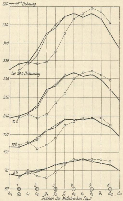
Fig. 6. Mittlere Dehnung an den Rändern des Bleches innerhalb des Teiles mit Nietlöchern. Zustand der Niete 1—3:
