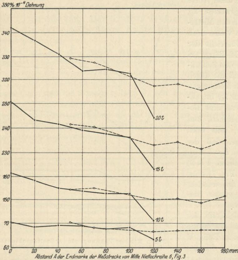
Fig. 13. Mittlere Dehnungen der Breitenschicht 3 (Fig. 7) bei wachsendem Abstande von Mitte Nietlochreihe 6 (Fig. 3). Die durch  $\times$  gekennzeichneten Beobachtungen für den Abstand  $A = 0$  entstammen der Tab. 17.
