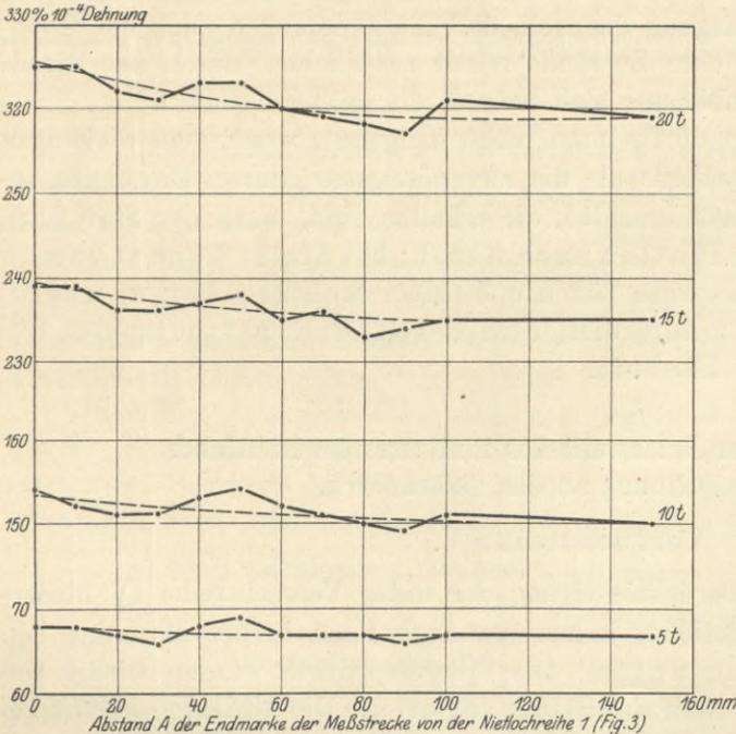
Fig. 5. Mittlere Dehnung in Proz.  $10^{-4}$  an den Rändern des Stabes bei wachsendem Abstände  $A$  der Meßstrecke von Mitte Nietlochreihe 1 (Fig. 3). II. Hinter der Lochreihe 1 mit aufgenieteten Platten.
