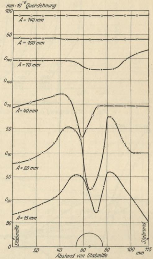
Fig. 21. Querdehnungen  $\epsilon_2$  der Längeneinheit an verschiedenen Stellen des Stabes, gegeben durch den Abstand von Stabmitte und den Abstand  $A$  vom Lochquerschnitt.
