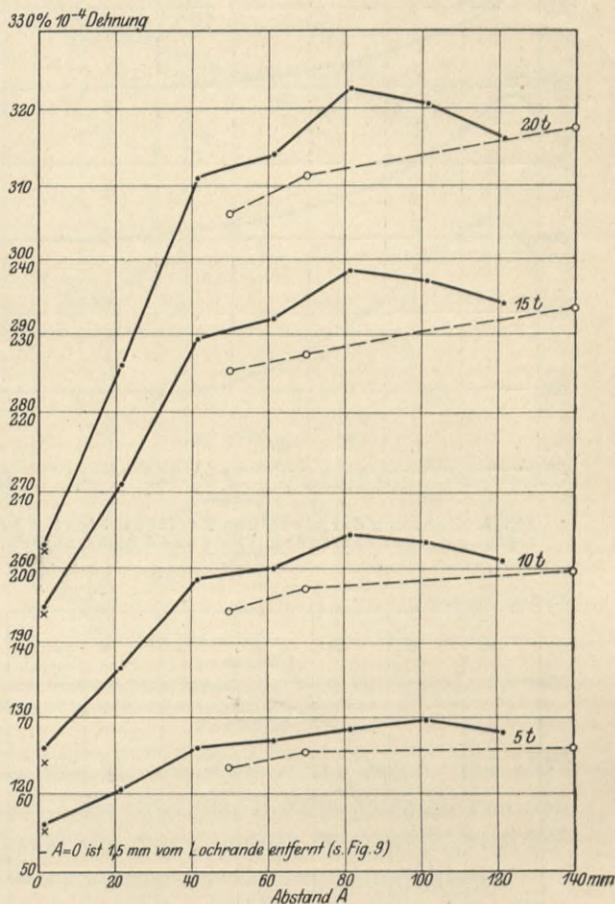
Fig. 14. Mittlere Dehnungen in der Breitenschicht 17 (Fig. 7) bei wachsendem Abstände  $A$  von Mitte Nietlochreihe 6 (Fig. 3).
