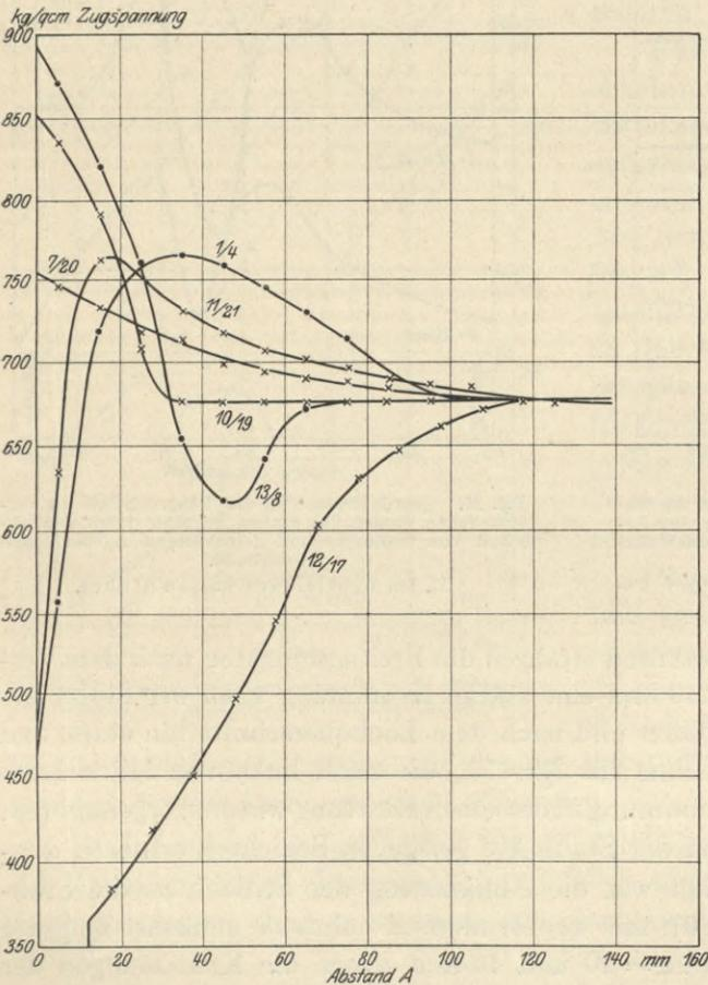
Fig. 23. Zugspannungen in den einzelnen Breitenschichten bei wachsendem Abstände  $A$  vom Querschnitt  $a \infty a$  (Fig. 7). Die Zahlen neben den Linien bedeuten die Nummern der Schichten.
