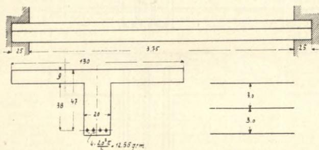
Ein Plattenbalken habe die in Fig. 82—84 angegebenen Abmessungen. Es sind die Spannungen im Beton und Eisen zu berechnen, wenn die Nutzlast 630 kg/qm ist.
