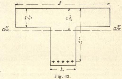
Bei der Berechnung wird nun angenommen, dass sich der Eisenquerschnitt im unteren Teile des Steges auf die wirksame Breite  $B$  der Platte verteilt. Die wirksame Plattenbreite soll nach den amtlichen Vorschriften auf jeder Seite zu höchstens  $\frac{1}{6}$  der Länge des Plattenbalkens angenommen werden.
