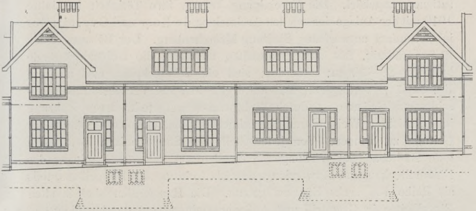
677 Abb. 67. Kleinhaus. Reihensbau; Baustellenbreite rund 6 m; Bauzeit 1894. Arnhem. Erbauer Gemeinnützige Baugesellschaft.
