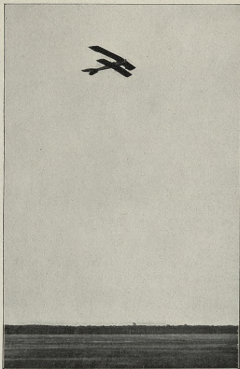
Abb. 35. Kumpfdoppeldecker im Fluge. Die Flügel zeigen die neuerdings bisweilen mit Erfolg angewendete „Pfeilform“, d. h. die Flächen sind leicht teilsförmig zurückgebogen, was die Gleichgewichtshaltung begünstigt.
