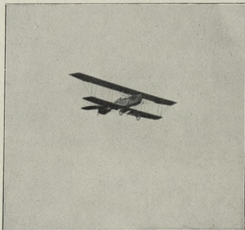
Abb. 16. Ein Rumpfdoppeldecker im Fluge mit übertragendem Oberdeck, dessen schräge Abstützung erkennbar ist.
