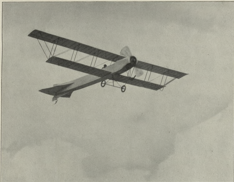
Abb. 18. Der französische Militärzwei-decker „Zodiac“. Im allgemeinen Aufbau ähnlich den Albatros- und L.-V.-G.-Doppeldeckern (Abb. 19 u. 20). Die überragenden Enden des Oberdecks sind herunterklappbar zu leichtem Transport und bequemerer Unterbringung.
