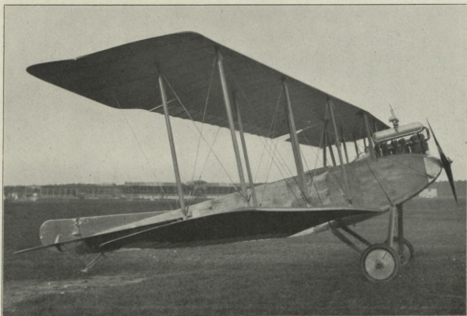
Abb. 19. Albatros-Rumpfdoppeldecker, Stahlrohrbau mit holzbelledetem Rumpfe, flog mit 200 kg Nutzlast in 7 Minuten, mit 300 kg Nutzlast in 9 Minuten (dazu der Führer) auf 800 m. Kühler liegt über dem Motor. Scheibenräder zur Verringerung des Luftwiderstandes.
