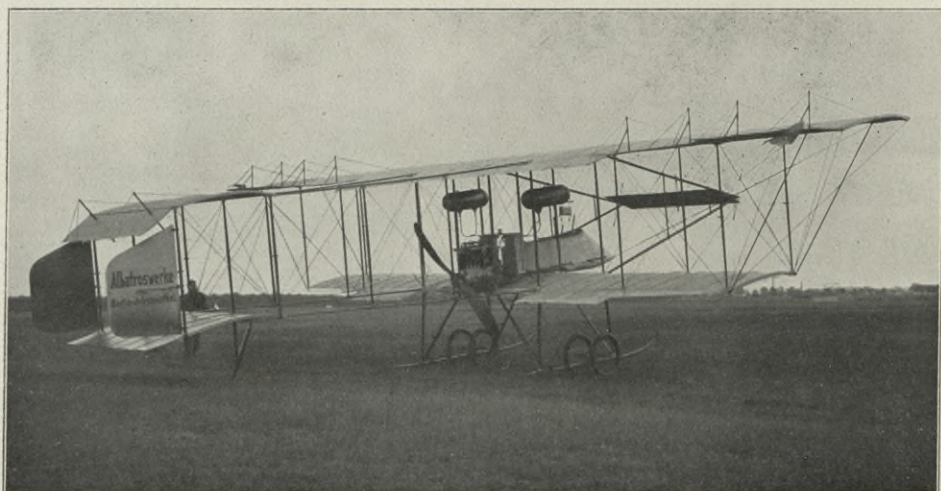
Abb. 17. Albatros-Militärdoppeldecker 1911. Motor hinter Führer und Passagier, Schraube hinter den Tragflächen. Höhensteuer vorn und hinten. Zwei Benzintanks. Hilfsklappen an den Flügelenden zur Schrägsteuerung. überragendes Oberdeck.
