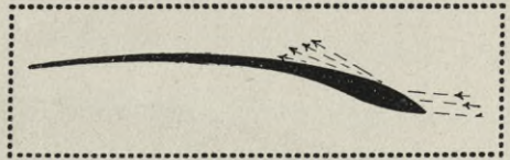
Abb. 4. Tragfläche nach Angabe des englischen Ingenieurs Phillips 1891. Durchaus moderne Kurve.
