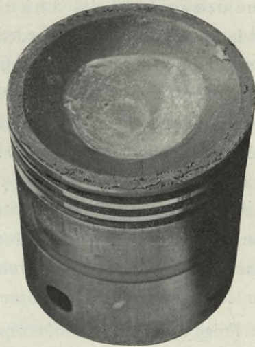
Bild 97. Knight-Motorkolben mit Glühstelle und Verkrustung.
