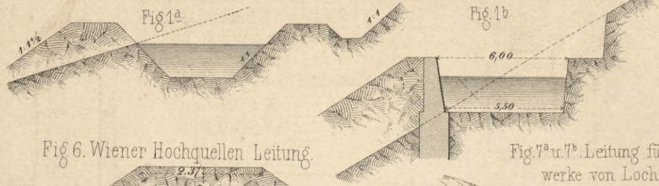
Fig 1 a u. b . Leitung für die Wasserversorgung von Marseille.
