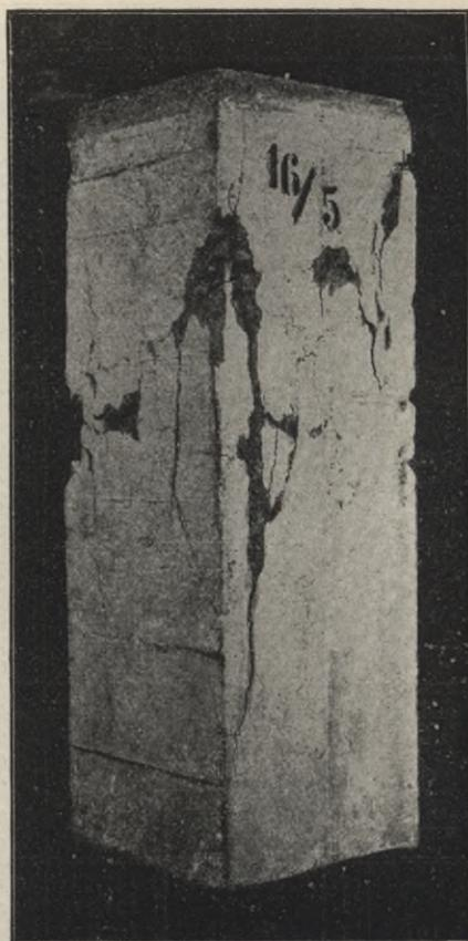
langen Säulen 2 und 1 erhalten und durch die dritte Linie C Abb. 69 mit den durch  $\times$  gekennzeichneten Beobachtungspunkten dargestellt sind; nach ihnen lieferte der Schleifenbügel geringere Festigkeiten als der einfache Bügel.
