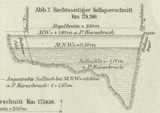
Abb. 3-8. Bezeichnende Querschnitte der Beobachtungsstrecke der Weichsel Km 168-178 bei einer Regelbreite von 375 m und 250 m.
