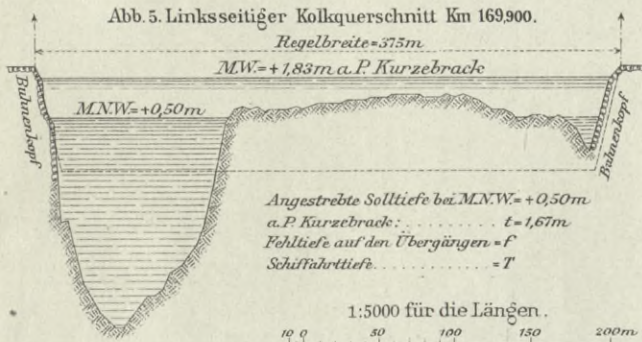
Abb. 3-8. Bezeichnende Querschnitte der Beobachtungsstrecke der Weichsel Km 168-178 bei einer Regelbreite von 375 m und 250 m.
