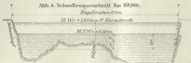
Abb. 3-8. Bezeichnende Querschnitte der Beobachtungsstrecke der Weichsel Km 168-178 bei einer Regelbreite von 375 m und 250 m.
