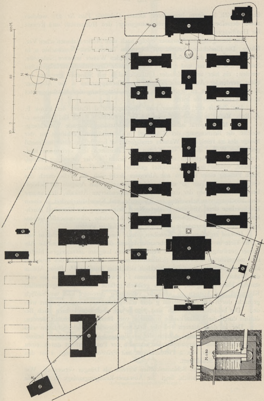
Übersichtsplan der Gebrauchsabwasserleitungen.
