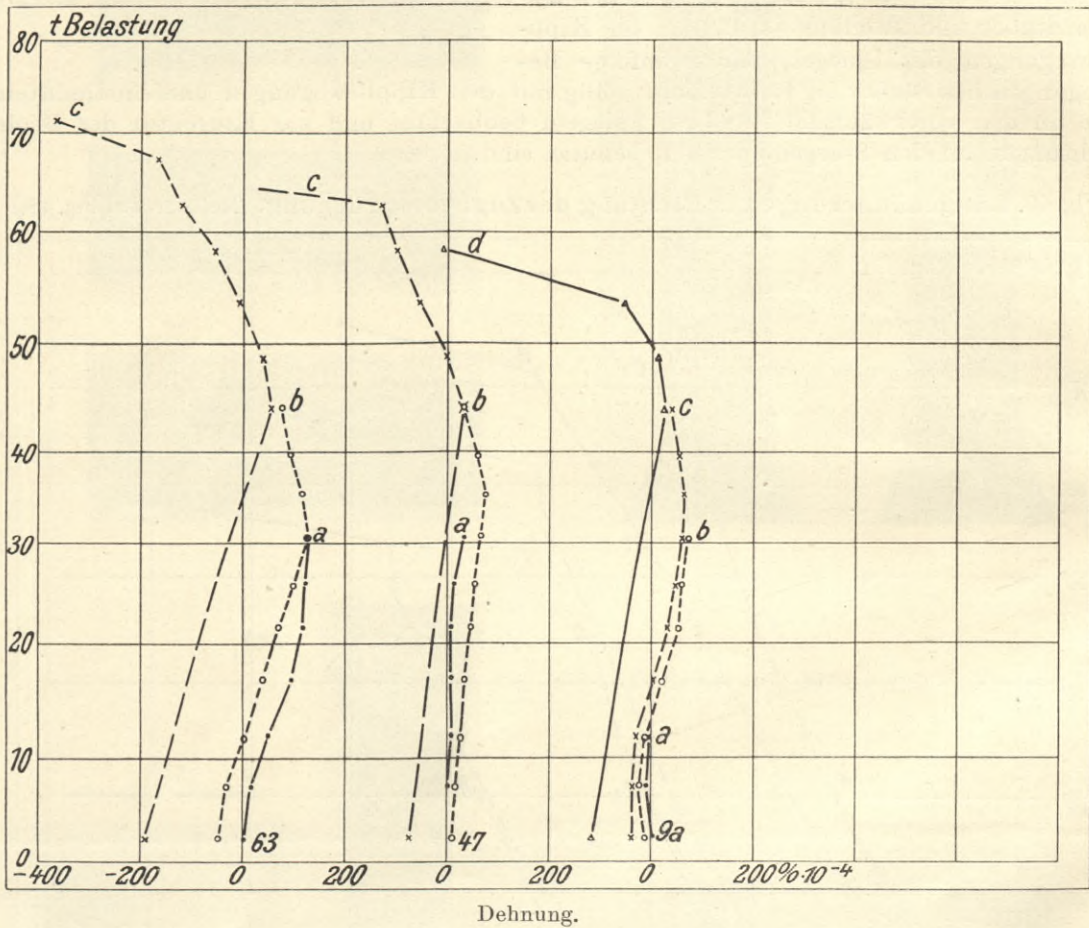
Fig. 50. Längenänderungen in d. Verbindungslinie d. Nietmitten. (Mefsstrecke II Fig 48.)
