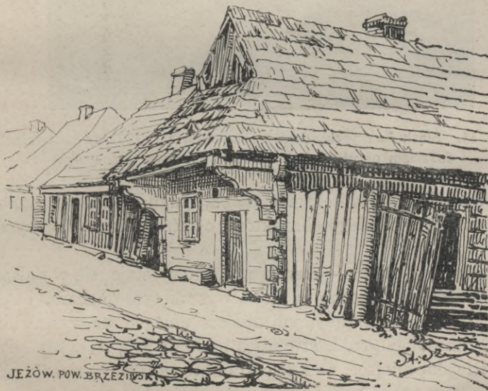
Rys. 13. Jeżów (pow. Brzeziński). Dom ze szczycikiem i okapem przybówym na rysiach.
