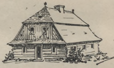
Rys. 24. Dach łamany, naczółkowy polski.
