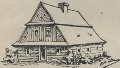
Rys. 23. Dach łamany polski, dwuspadowy, ze szczytem.
