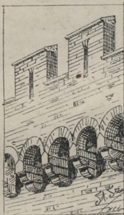
Rys. 64. Hurdyca na murach zamków średniowiecznych Zachodu, jako dalsze rozwinięcie zasady nawieszania ścian (por. z rys. 60, 61, 62).
