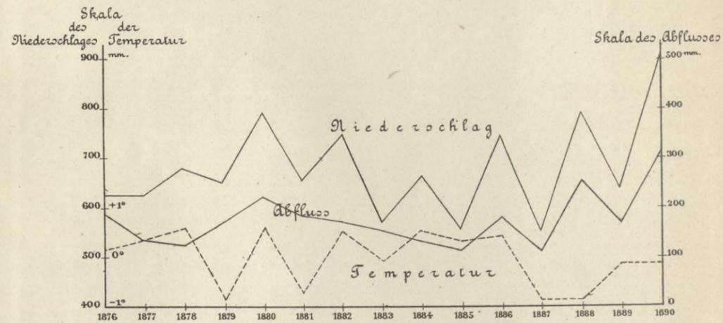
Fig. 11. Niederschlag, Temperatur u. Abfluss im Moldaugebiete 1876/90.
