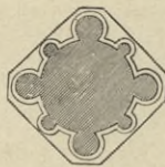
11. Grundriss eines gotischen Pfeilers.
