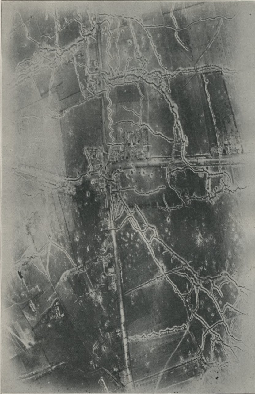
Diese Sitieraufnahme aus etwa 800 m Höhe gibt ein klares Bild eines stark befestigten Grabensystems. Die Stellung hat in manchen Teilen stark unter Artilleriefeuer gelitten. In einzelnen Gräben sind die Schuterverwehren deutlich zu erkennen. In der Mitte des Bildes der Rest eines einstmaligen Dorfes, ein Trümmerhaufen, eingesaumt von Gräben und Wehren; überall sind Granatrichter zu sehen; an dieser Aufnahme von Hauptmann Thumm ist nicht das Geringste geändert oder retuschiert worden.
