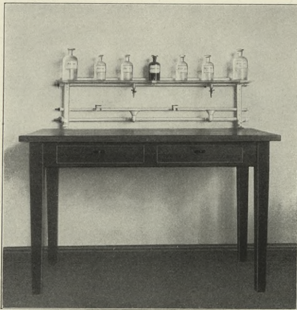
Abb. 12. Montierung der Leitungen an beweglichem Tisch.
