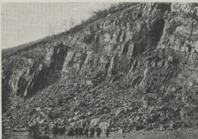
Abb. 9 Grauwacken-Steinbruch Lasbeck der „Westfälischen Stein-Industrie“ in Nachrodt, Wirkung eines Sprengschusses mit einer Ladung von 10 000 kg Pulver und 75 kg Dynamit
