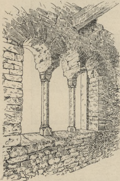
Innere Ansicht des 4fachen Fensters auf der Westseite im obersten Thurmgeschoße.
