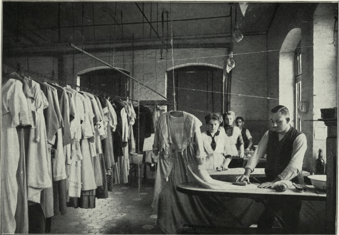
Detachier-Raum. Einzelentfernung von Flecken nach stattgefundener chemischer Reinigung.
